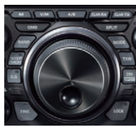
Dial exterior de VFO multiuso
